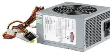
Le bloc d'alimentation est caractérisé par sa puissance, qui conditionne le nombre de périphériques que l'ordinateur est capable d'alimenter. La puissance du bloc d'alimentation est généralement comprise entre 350 et 1000 Watts.
